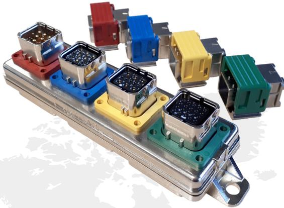
Boîtier de distribution d'alimentation électrique et de données pour système IFE en composite métallisé équipé de modules SIM EN4165 et intégrant un circuit imprimé multi-couches.
